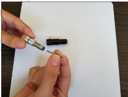
Figura 8.2 Después de desenroscar la porta navajas.
