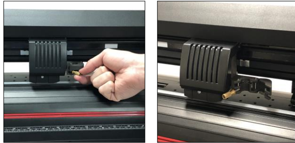
Figura 3.15 Proceso para abrir sujetador (izquierda a derecha).
