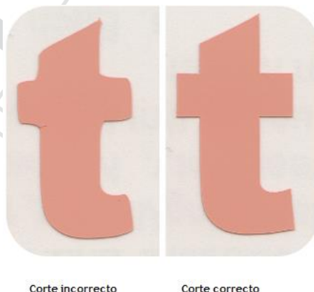
Figura 6.5 Diferencia entre una mala y una buena calibración.
