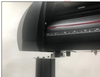
Figura 3.9 Patas del plóter dentro de los orificios.
