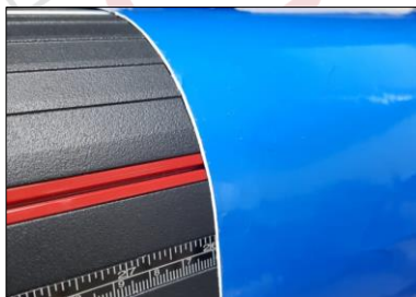
Figura 7.2 Alineación de vinil con cinta métrica.
