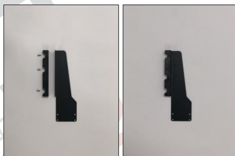
Figura 3.5 Antes (izquierda) y después (derecha) de armar ambos soportes para cilindros.
