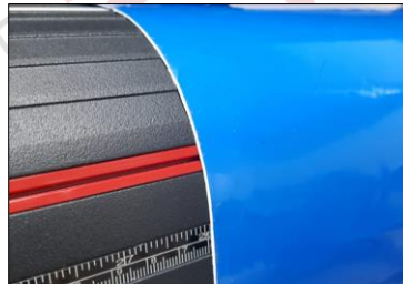
Figura 7.2 Alineación del vinil con la cintra métrica.
