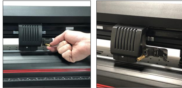
Figura 3.15 Proceso para abrir sujetador (izquierda a derecha).
