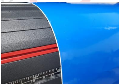
Figura 7.2 Alineación de vinil con cinta métrica.
