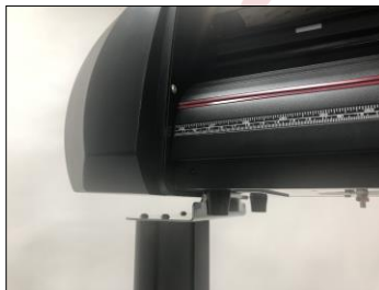
Figura 3.9 Patas del plóter dentro de los orificios.
