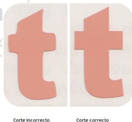
Figura 6.5 Diferencia entre una mala calibración y una buena calibración.
