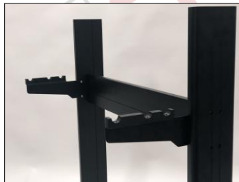
Figura 3.6 Soportes de cilindro fijos a la columna.
