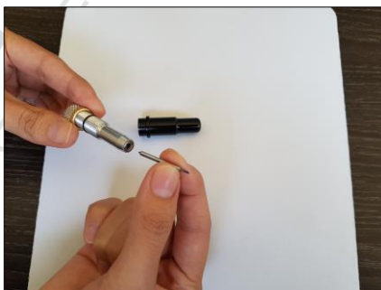
Figura 8.2 Después de desenroscar la porta navajas.
